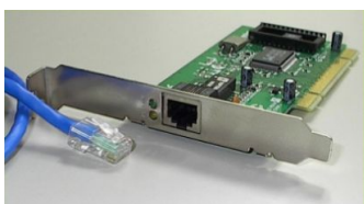
Placa de rede via cabo
